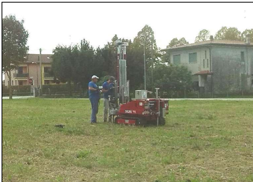
Foto 1: Esecuzione della Prova penetrometrica statica
